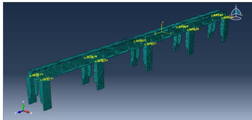
**Figure 2 : Finite element model**
