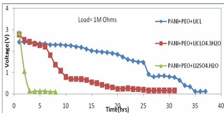
**Fig. 1: Discharge characteristic curve for a) Li |PANI PEO LiCl|(C+I<sub>2</sub>) b) Li |PANI PEO LiClO<sub>4</sub>.H<sub>2</sub>O|(C+I<sub>2</sub>) c) Li |PANI PEO Li<sub>2</sub>SO<sub>4</sub>. H<sub>2</sub>O|(C+I<sub>2</sub>)**
