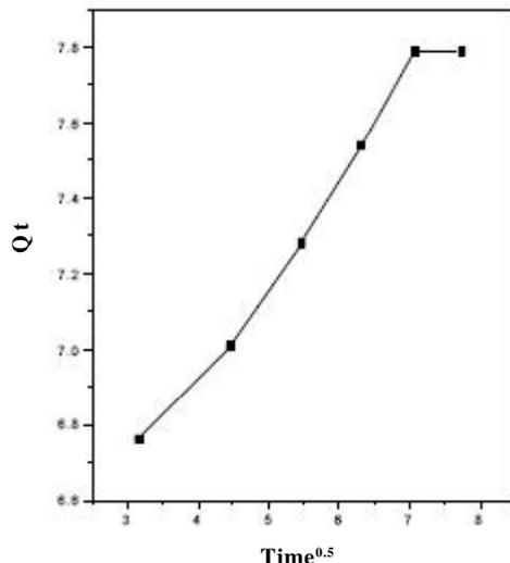
Figure 5 : Intraparticle diffusion effect. [Cr]=10mg/L; Adsorbent dose=50mg/50 ml; pH=7
