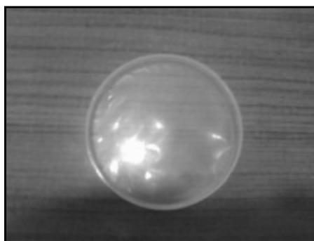
**Fig. 1:** Polymer electrolyte films of PAN :  $\text{NH}_4\text{CF}_3\text{SO}_4$
